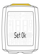
Le VDO M5 vous permet de régler la circonférence de roulement de vos roues en millimètres ou en sélectionnant les pneus adéquats dans un tableau.
