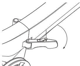
**1.** Éteindre l'appareil via le bouton on/off (M). Déverrouillez le loquet de la barre centrale comme montré sur le dessin.
