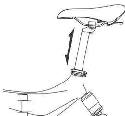
**1.** Desserrer le collier sous la tige de selle, ajustez la selle jusqu'à ce que sa base soit 25~50mm plus haute que la jambe du cycliste (Hauteur de conduite préconisée) puis resserrez le collier.
