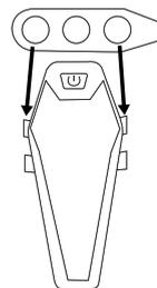
**3.** Utiliser l'attache en caoutchouc fournie pour attacher le feu de route sous la selle grâce aux crochets comme ci-dessus.
