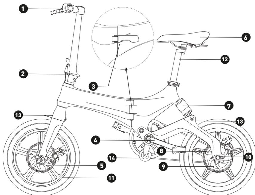
(1). Guidon, écran, accélérateur, sonnette et poignées de frein (2). Loquet de pliage du guidon (3). Loquet de pliage du cadre (4). Pédales (5). Frein avant (6). Selle réglable (7). Suspension arrière (8). Frein arrière (9). Moteur (10). Aimant roue (11). Bande réfléchissante (12). Emplacement feu de route à ajouter (13). Emplacement garde-boues à ajouter (14). Roue de protection du plateau
