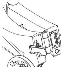
**4.** Installer la batterie dans son emplacement puis verrouillez-la avec la clé. Retirer la clé et conservez-la. Rabattre la poignée de la batterie vers l'intérieur et dépliez le cadre du vélo.
