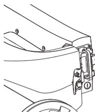
**2.** Tourner et plier le cadre du vélo pour l'ouvrir, déverrouillez la sécurité anti-ivol de la batterie avec la clé.
