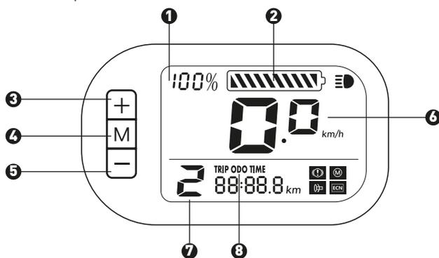
(1). Niveau de batterie % (2). Niveau de batterie (3). Bouton + (4). Bouton M (5). Bouton - (6). Vitesse (7). Niveau de vitesse (1 : 15 km/h ; 2 : 20 km/h ; 3 : 25 km/h) (8). Mode d'affichage
