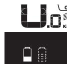
Hvis begge batteriene på en eBike med to batterier, lades på sykkelen, vises ladefremdriften til begge batteriene på displayet (på bildet lades det venstre batteriet). Hvilket av de to batteriene som lades for øyeblikket, vises også av indikatorene som blinker på batteriet.
