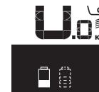
Lors de la recharge des deux batteries d'un vélo à deux batteries, l'écran indique l'état d'avancement de la charge des deux batteries (sur la figure ci-contre, la batterie de gauche est en train d'être chargée). La batterie en train d'être chargée est aussi reconnaissable au fait qu'elle clignote.
