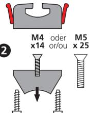
**Montage Miniadapter** Der Adapterkopf ist in 90° Schritten drehbar **1**. Zur Veränderung der Einschubrichtung die beiden Schrauben im Sockel lösen **2**, Kopf drehen und Schrauben um 90° versetzt wieder eindrehen. Je nach Montageart, muß die passende Innensechskantschraube vor dem Zusammenbau im Sockel einge- steckt sein (für Bandmontage die mitgelieferte **M4**).
