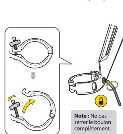
3. Installer le garde-boue arrière sur les jambages de la fourche et NE PAS serrer les boulons de tension complètement. Placer le carton d'indication sur le garde-boue et ajuster le garde-boue afin que l'espace entre celui-ci et le pneu soit de minimum 30 mm comme illustré.
