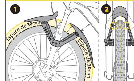
1. Afin d'éviter que le garde-boue n'entre en contact avec le cadre lors de la compression de la fourche à suspension, il est recommandé de garder un espace de 30 mm entre le garde-boue arrière et le pneu. Dépasser 30 mm peut endommager le vélo.
