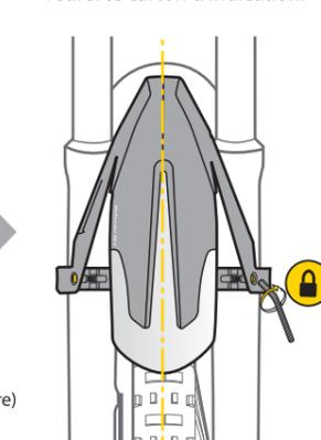
5. Installer les jambes du garde-boue avant juste au dessus de celles du garde-boue arrière comme illustré. Serrer les boulons de tension.
