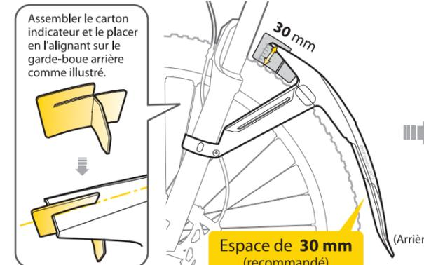
4. Vérifier que le garde-boue arrière soit aligné avec le pneu. Serrer le boulon de tension et retirer le carton d'indication.
