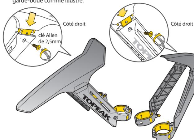
2. Serrer les boulons de tension aux quatre jambes.
